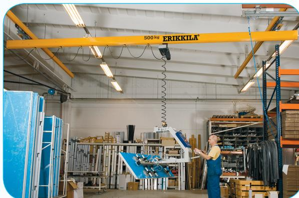
PROSYSTEM® Одно- и двухбалочный кран может быть установлен на опорные балки помещения или на опорные свободностоящие рамы. Смотрите стр. 8 .
